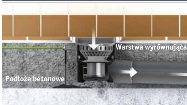
Posadzki betonowe i z płytkami bez izolacji
