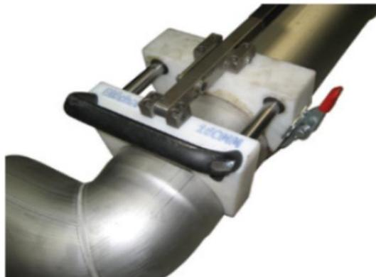
**Figure 6 - Outils pour emboitage  $DN \geq 160$**
